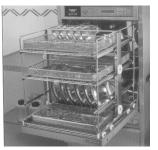
superiori a 90°C, offrono il vantaggio di associare l'attività di detersione ad un processo di disinfezione termico.
